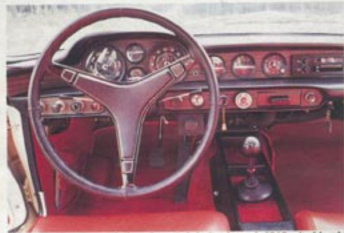
Sicherer, aber etwas fader: Coupé-Arbeitsplatz ab 1969 mit „blendfreiem“ Holzfurnier und Lenkrad mit versenkter Nabe.
