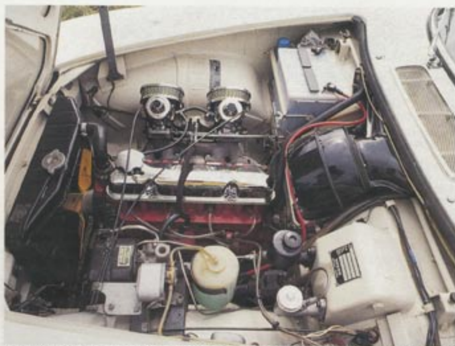
Immer vier Zylinder unter der „Ferrari-Haube“: Hier ist's eine „B 18 B“-Maschine mit zwei SU-Flachstromvergassern, die das Coupé auf über 170 km/h Spitze treibt.
