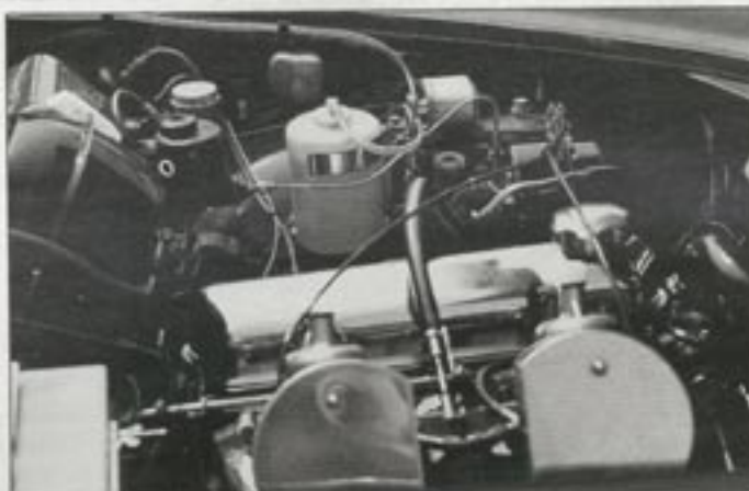
Zwei SU-HS6-Flachstromvergaser versorgen den B18-Motor mit zündfähigem Gemisch.
