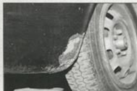
Durch Spritzwasser ist das Unterteil des hinteren Abschlußbleches stark rostgefährdet.
