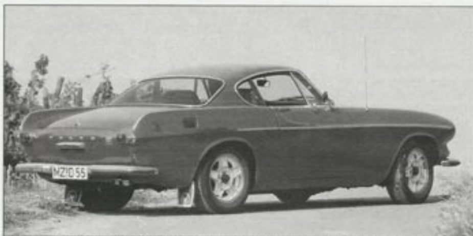
Ein schöner Schwede: der Volvo P 1800 E! Die Linienführung kann auch heute noch begeistern. Beflügelt wurde er von dem 1986-Kubikzentimeter-B20-Motor, der bis zu 124 PS leistete.
