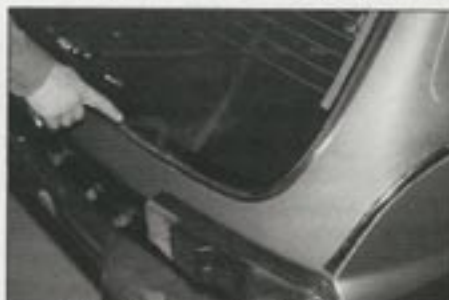
Beim 1800 ES waren zur Rostvorsorge an der Heckklappe Wasserablaufschräuche angebracht.
